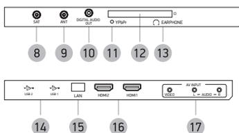
8 Разъем для подключения спутниковой антенны
