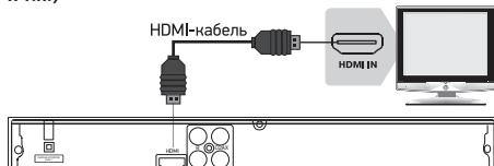
Соедините HDMI-разъем цифрового устройства отображения с HDMI-разъемом DVD-плеера (не входит в комплект поставки).
