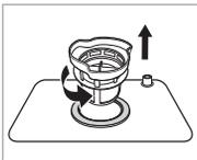
Большие остатки пищи можно очистить, промыв фильтр под проточной водой. Для более тщательной чистки используйте мягкую щетку для чистки.
