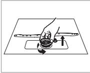
Поднимите фильтр тонкой очистки от основного фильтра.
