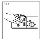
Заполните основной контейнер для моющего средства перед каждым циклом мытья посуды. Отсек для предварительной мойки рекомендуется использовать в случае сильного загрязнения.
