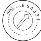
Рекомендуемое положение регулятора - "4". В случае, если на посуде остаются капли воды, установите следующее положение регулятора. Если на посуде остаются белесые полосы или голубоватая пленка на прозрачных поверхностях и стальной посуде, уменьшите количество используемого ополаскивателя, повернув регулятор по часовой стрелке на предыдущее положение.
